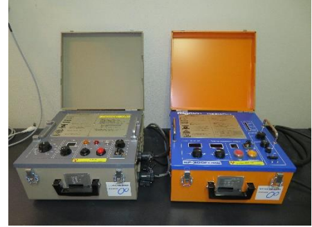
エックス線発生装置 写真上：発生器本体 写真下：制御BOX
